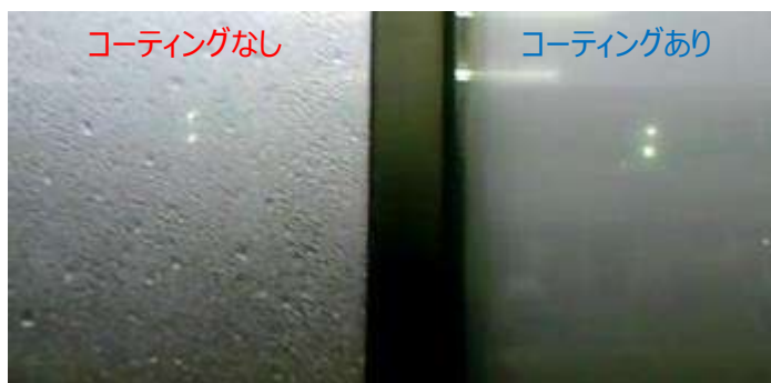
冷暖ガラスシールド塗布・未塗布の結露状態の違い
